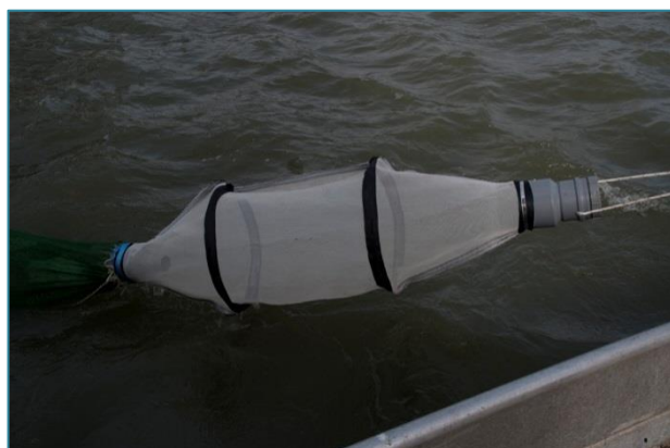
Figuur 5: glasaalnet aan het uiteinde van vispassagefuik
