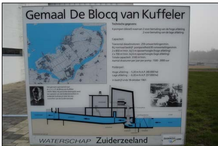
Figuur 6.2: Het gemaal De Blocq van Kuffeler is een belangrijk knelpunt in de verbinding binnendijks-buitendijks
