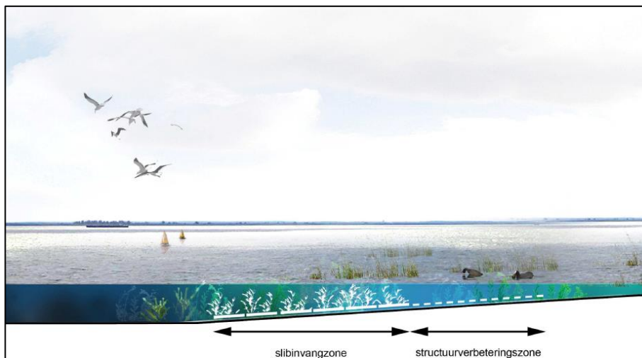
Figuur 5-9: De aanleg van kunstmatige waterplanten op een diepte van 2-3 meter. De verwachting is dat in de loop van de tijd daar natuurlijke waterplanten tussen gaan groeien en zich uitbreiden in de ontstane luwte [bron: Goijer et al., 2012]
