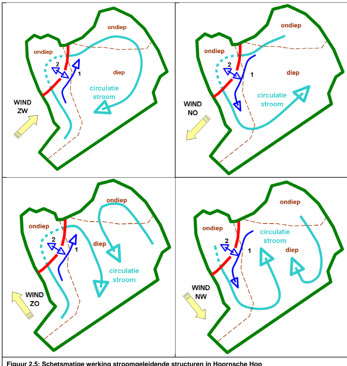
Figuur 2.5: Schetsmatige werking stroomgeleidende structuren in Hoornsche Hop
