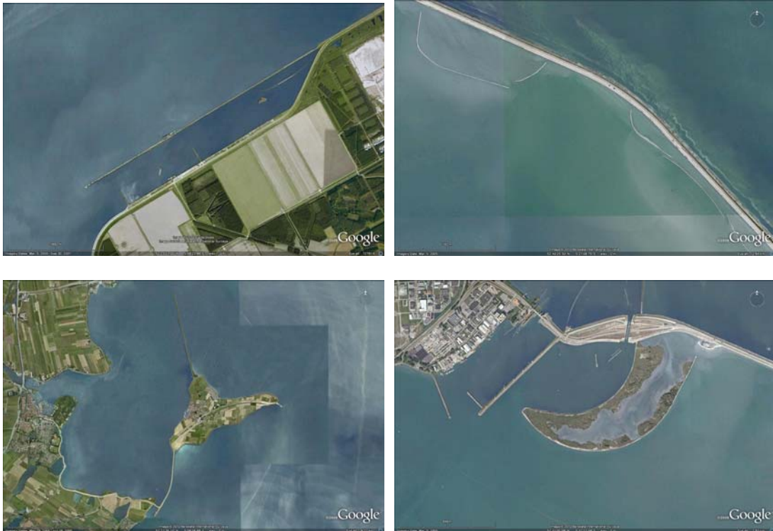
Figuur 4.1: Enkele voorbeelden van Luwtestructuren in het Markermeer: linksboven dam langs de Oostvaardersdijk; rechtsboven 'Hockeysticks' langs de Houtribdijk; linksonder luwtedammen bij Marken; rechtsonder Naviduct en moeras
