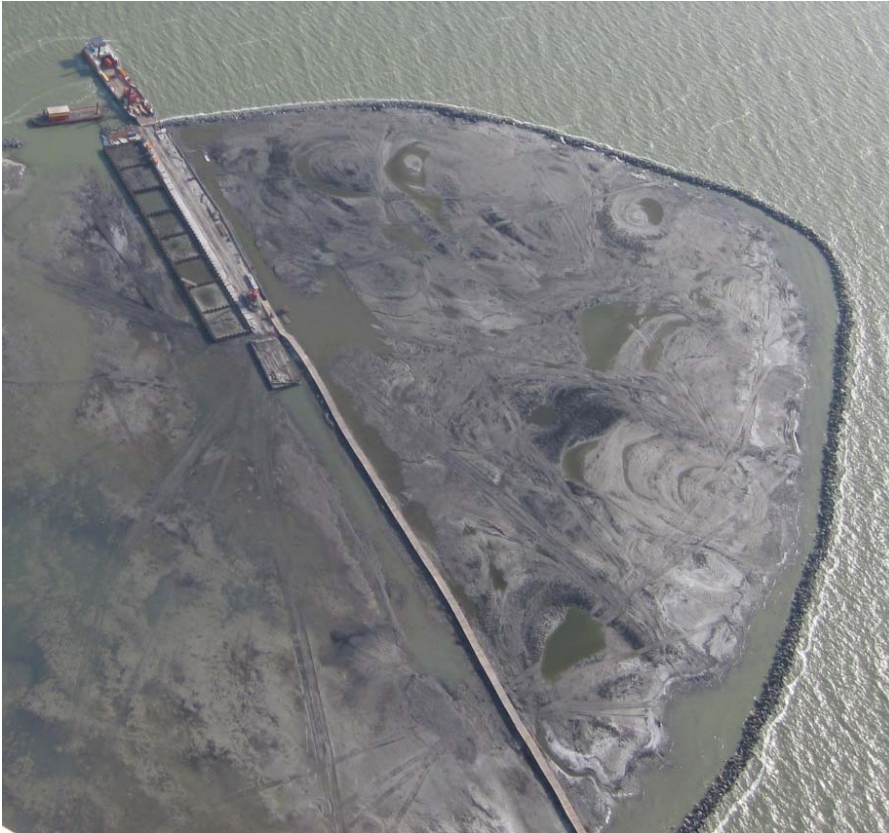
Figuur 15: Bovenaanzicht pilot tijdens aanleg: duidelijk zijn de cirkelvormige structuren te zien t.g.v. de aanleg met transportbanden (puntdepositie)
