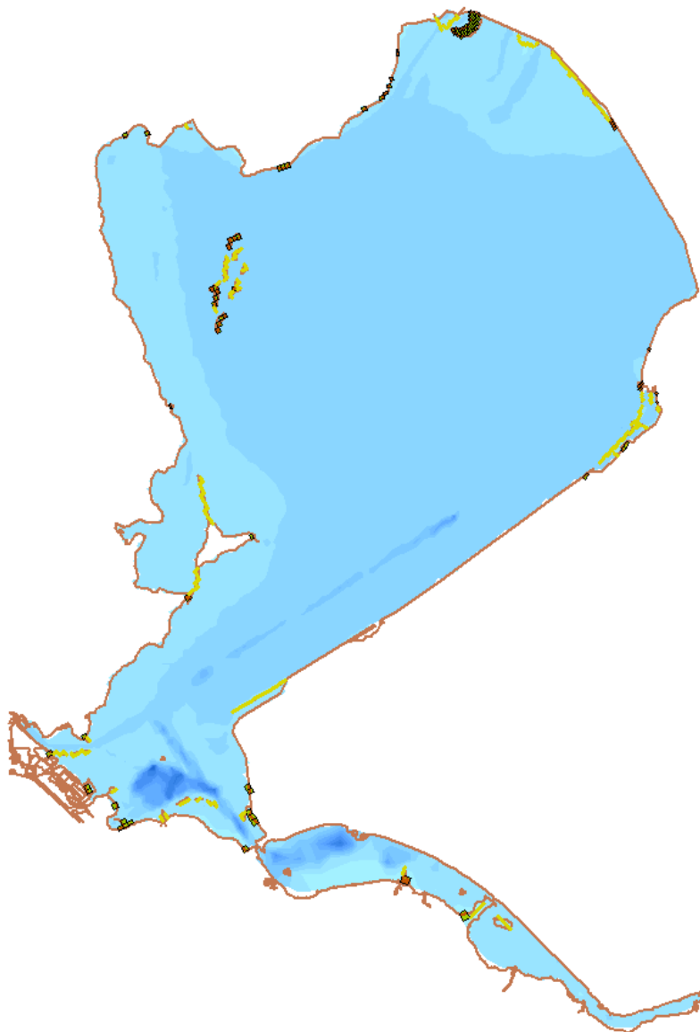
Figuur A.4. Implementatie van alternatief 3 (Archipel Oost) in slibmodel, landgrenzen zijn aangegeven met een bruine lijn, gebruikte diepte ten opzichte van NAP is aangegeven in blauwtinten, voor obstakels (zoals eilanden, strekdammen) kleiner dan een rekencel worden dunne dammen (gele lijnstukken) gebruikt en voor obstakels ter grootte van een rekencel wordt de betreffende rekencel droog gezet (groen met zwart omliggende cellen).
