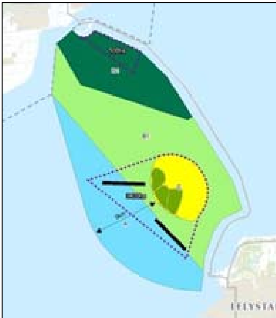
Figuur 3.23: Uitsnede van meest waarschijnlijke situering Marker Wadden (geel is eindbeeld moeras, groen daarbinnen fase 1) met twee diepe geulen (zwarte strepen)
