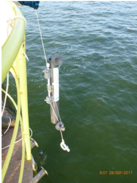
Figuur 2.8: Monstername met een Niskin go-flo bottle (Movares en Mateboer, 2012a)
