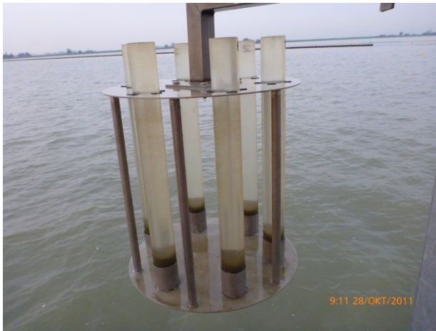
Figuur 4.25 Voorbeeld van een sedimentval. Observaties van de 6 individuele buizen worden gemiddeld
