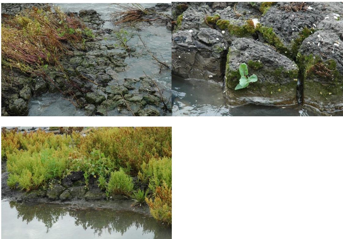
Figuur A.8 Voorbeelden van klink en rijping van de droogvallende delen van het in de pilot aangebrachte holocene materiaal (Bron foto materiaal Royal HaskoningDHV 19-8-2015)
