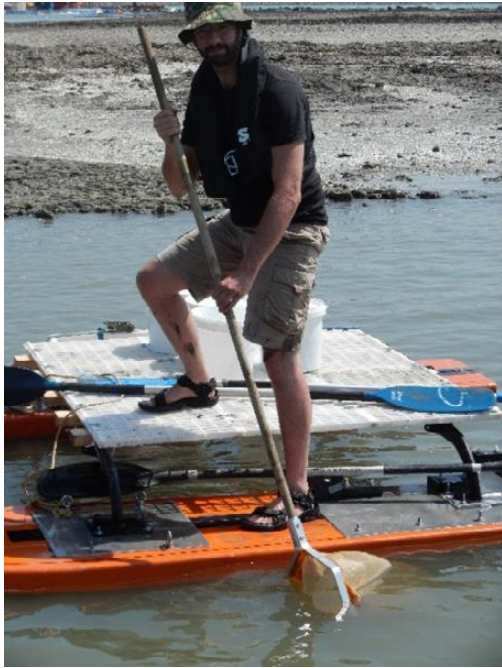
Foto 2 Drijvende constructie voor monsternamen in zeer ondiep water.
